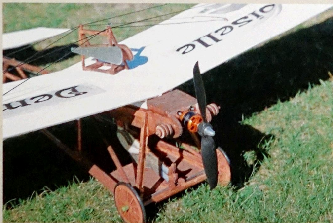
Die Vorderansicht: oben die Tankattrappe mit Flügelverspannung, vorne der Außenläufer AL 28-09
